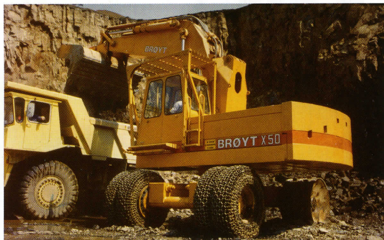
En X50 lastemaskin i et masseuttak i Tyskland. Vekt 44500 kg med 4000 l skuffe. (Foto: Trygve Vasvik)
