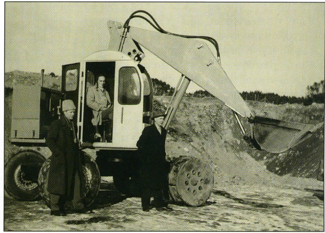
Hydraulisk maskin nr. 4 konfigurert som lastemaskin. Denne ble solgt til Rogaland Vegvesen. Ingebret står foran til venstre i bildet, Kristian til høyre. (Foto: Reid Skjærpe)
