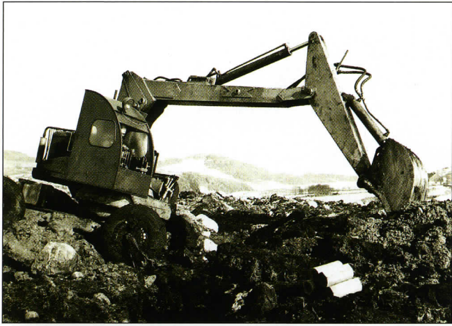
Den hydrauliske prototype Brøyt X i arbeid på Frøyland. Vekt med utstyr 6600 kg. (Foto: Jærmuseet)
