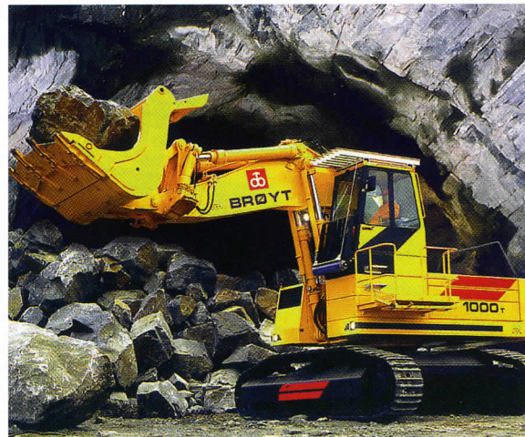
En Brøyt D1000 med belte. Vekt 64200kg med lasteskuffe 4400 l. (Foto: Janne Nilsson)
